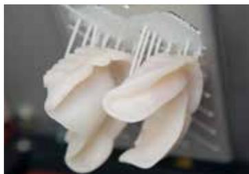
Gedruckte monolithische Einprobekörper
