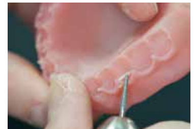
Verschleifen der Supportansätze und Störstellen
