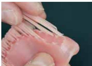
Schnelles Entfernen der Supportstrukturen (Gestaltung möglich mit SolFlex 3D-Druckern)
