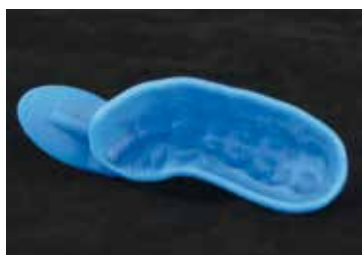
Teillöffel in hohen Schichtstärken gedruckt
