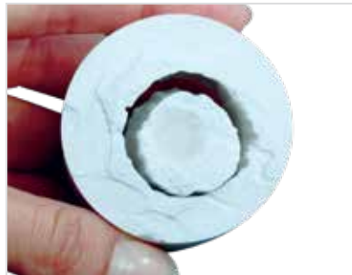
e) Grobausbettung mit \text{Al}_2\text{O}_3 bei max. 4 bar Druck. Vorsichtiges, präzises Abstrahlen mit Glasperlen (mittlere Körnung) bei max. 2 bar Druck.
