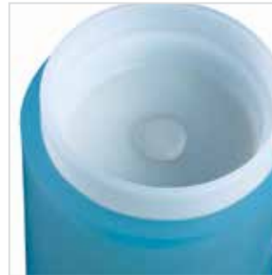
c) Nach Abbinden der Einbettmasse Muffel entformen.
