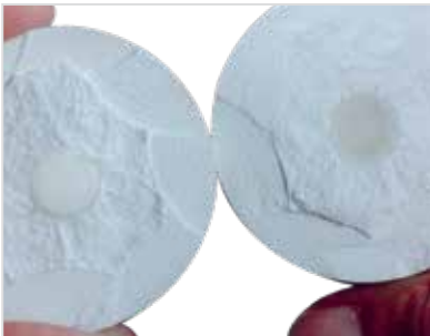
d) Getrennte Muffel am Übergang von Stempel zum Presskegel.
