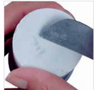
d) Mit Gipsmesser Unebenheiten glätten.
