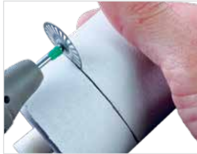
b) Mit Trennscheibe ringsum Sollbruchlinie erzeugen.
