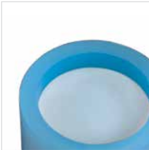
a) Mit leichter Vibration Einbettmasse in die Muffel eingießen.
