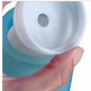
b) Nach ausreichender Befüllung Muffellehre positionieren.
