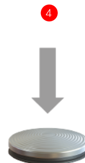
4 Fussschalter wenigstens 30 Sekunden lang drücken
