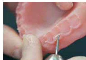
Verschleifen der Supportansätze und Störstellen
