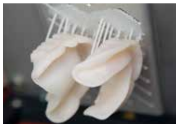
Gedruckte monolithische Einprobekörper
