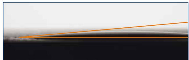
V-Posil Heavy Soft Fast / V-Posil Mono Fast, abgebunden, Kontaktwinkel < 6°
