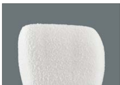
Túl vastagon vagy többszörösen felhordott festék kitölti a felületi textúrát. Kiégetés után ez többé már nem lesz látható. A fogpótlás csillogása természetellenesen erős, és a felületen apró buborékok keletkezhetnek.
