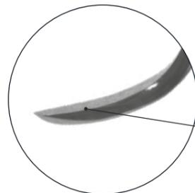
AN EINER SCHARFEN SCHNEIDEKANTE IST KEIN LICHTREFLEX ERKENNBAR (SIE GLÄNZT NICHT).
