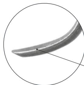
AN EINER STUMPFEN SCHNEIDEKANTE REFLEKTIERT DAS LICHT (SIE GLÄNZT).
