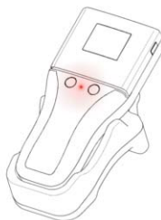
Rys. 4: Ładowanie baterii jest oznaczone jednostajnie świecącą się czerwoną diodą LED (To nie wskaźnik ostrzeżenia!).
