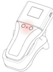
Abbildung 4: Das Laden der Akkus wird durch eine dauerhaft leuchtende LED angezeigt. (Hierbei handelt es sich nicht um einen Warnhinweis!)
