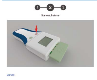
Abbildung 21: Schritt 2 - Drücken Sie zum Starten die pink-farbene Taste
