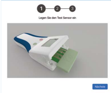
Abbildung 20: Schritt 1 - Setzen Sie den Testsensor in das Handgerät ein
