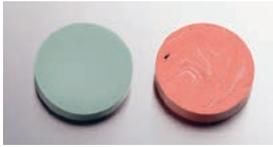
Abb. 27: Bessere Mischqualität von 3M™ Express™ 2 Penta™ Putty aus dem Mischgerät Pentamix™ (links) im Vergleich zu einem per Hand angemischtem Putty (rechts, 3M™ Express™ STD Putty).
