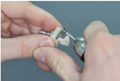
Restauration mit einer Trennscheibe oder geeignetem Hartmetallfräser vom Abstichzapfen trennen.
