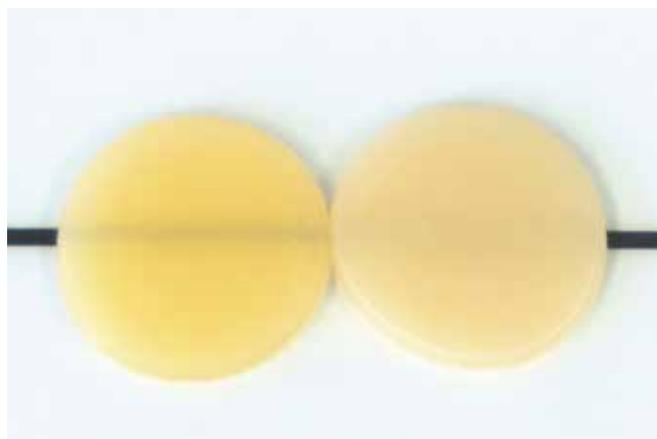
Farbprobekörper GrandioSO Unlimited (Cluster-Shade A3) vor der Lichtpolymerisation (links) und nach der Lichtpolymerisation (rechts)
