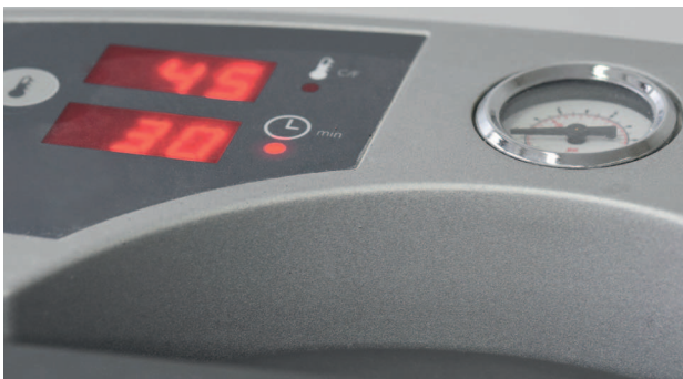
18. Bei 45 °C 15 Minuten bei 3 bar polymerisieren
