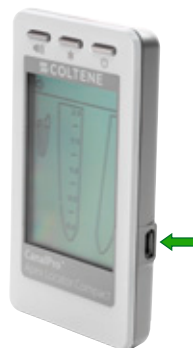
Odprtina za merilni kabel
