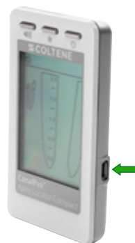
Inngang for målekabel
