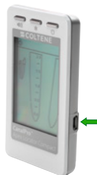
Conexión del cable de medición
